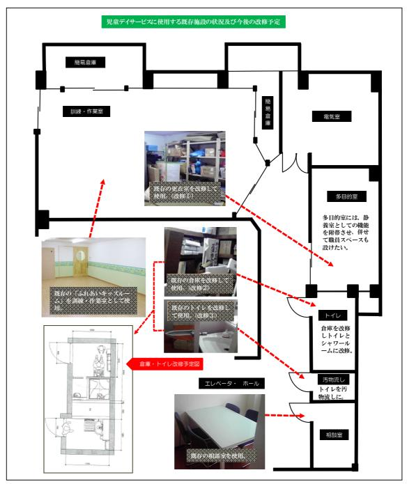
改修①=既存の更衣室を改修して多目的室とする。この場合、上り框を撤去し、床面とフラットな状態にする。多目的室には、医療用ベットを配置するなどして「静養室」としての機能も附
